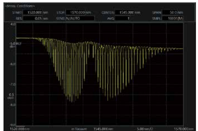
氨化氢 \text{H}_3\text{C}_{14}\text{N} 的吸收光谱测量(AQ6375E)
