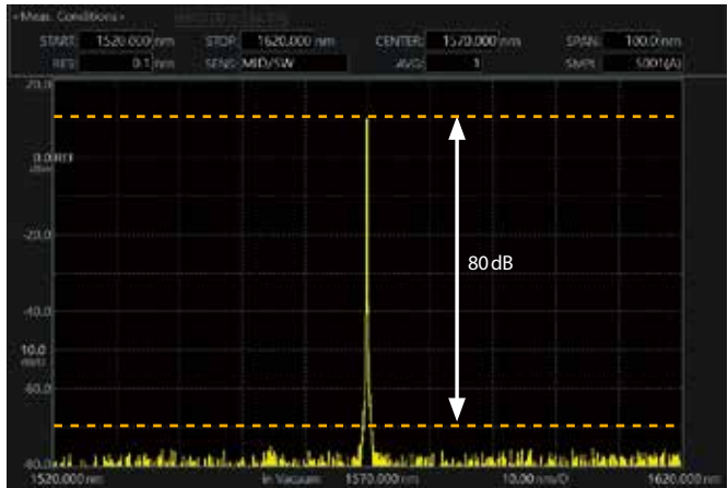
AQ6370E、灵敏度设置: MID 大动态测量模式: ON、典型值
